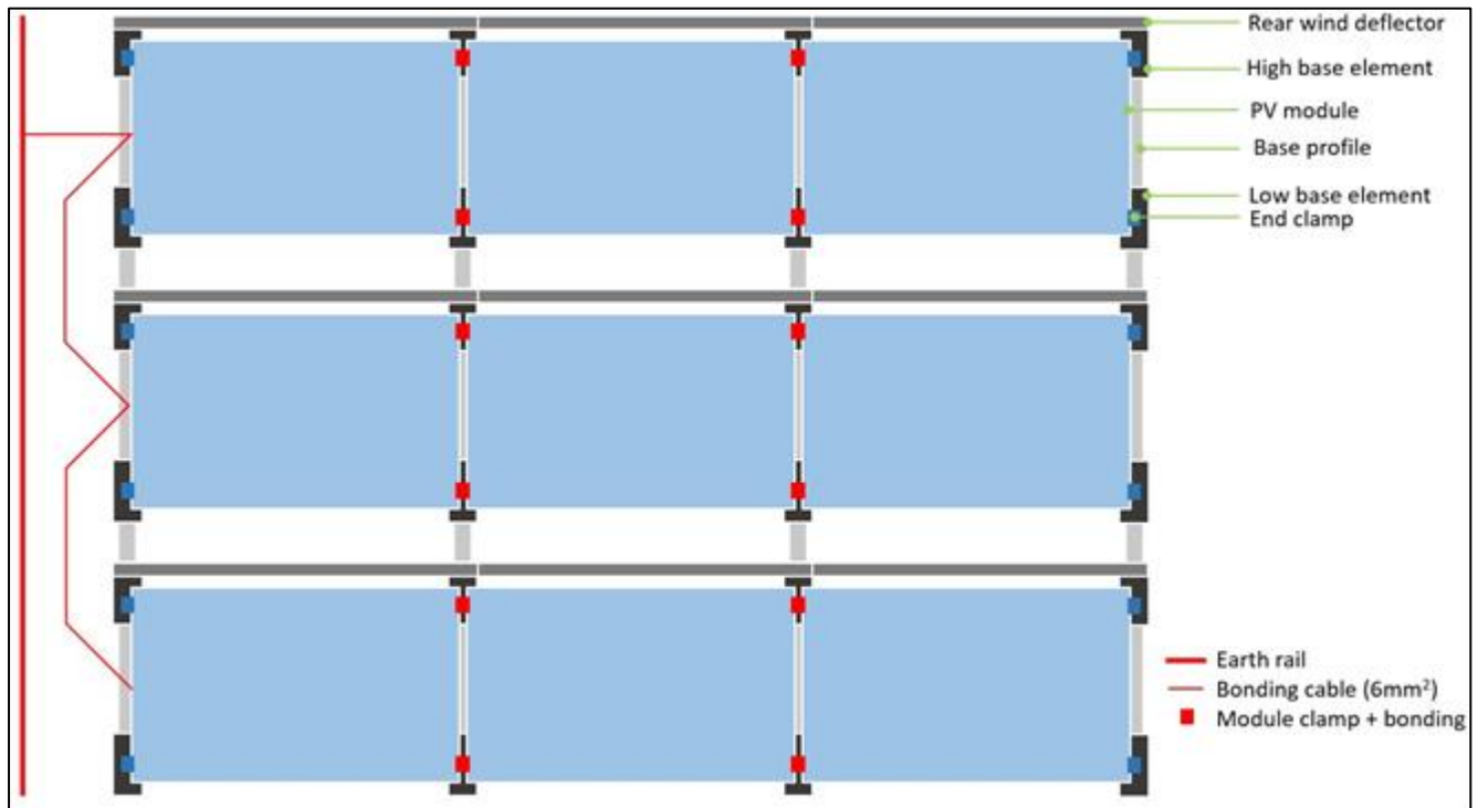
Figuur 12: Schematische weergave vereffening van meerdere rijen.
